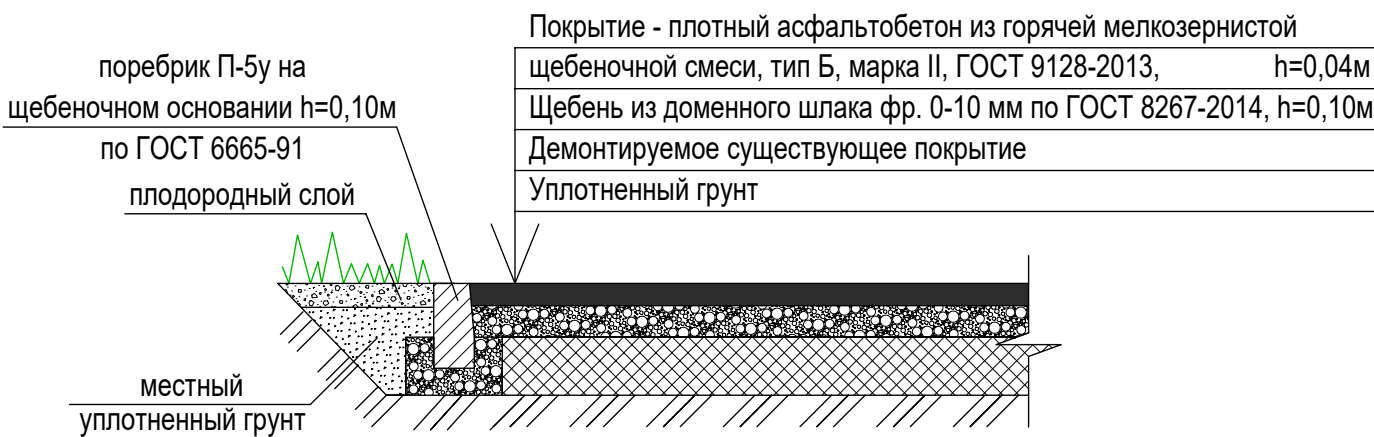
КОНСТРУКЦИЯ ПОКРЫТИЯ ТРОТУАРОВ (Тип 4)
